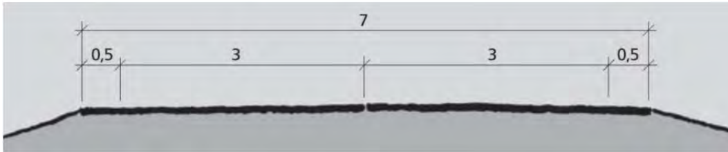
Tverrprofil A2, industriveg (frå Statens vegvesen Handbok 017)
